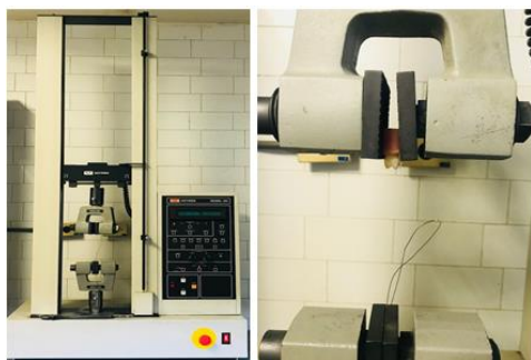
Figura 6. A) Máquina universal de pruebas INSTRON. B) Colocación de la muestra para pruebas.
