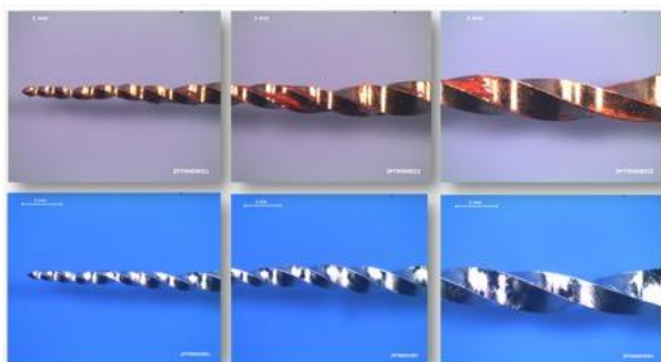
Figura 3. Instrumentos Wave One Gold Primary sucios y teñidos (superior). Instrumentos tratados con láser (inferior).
